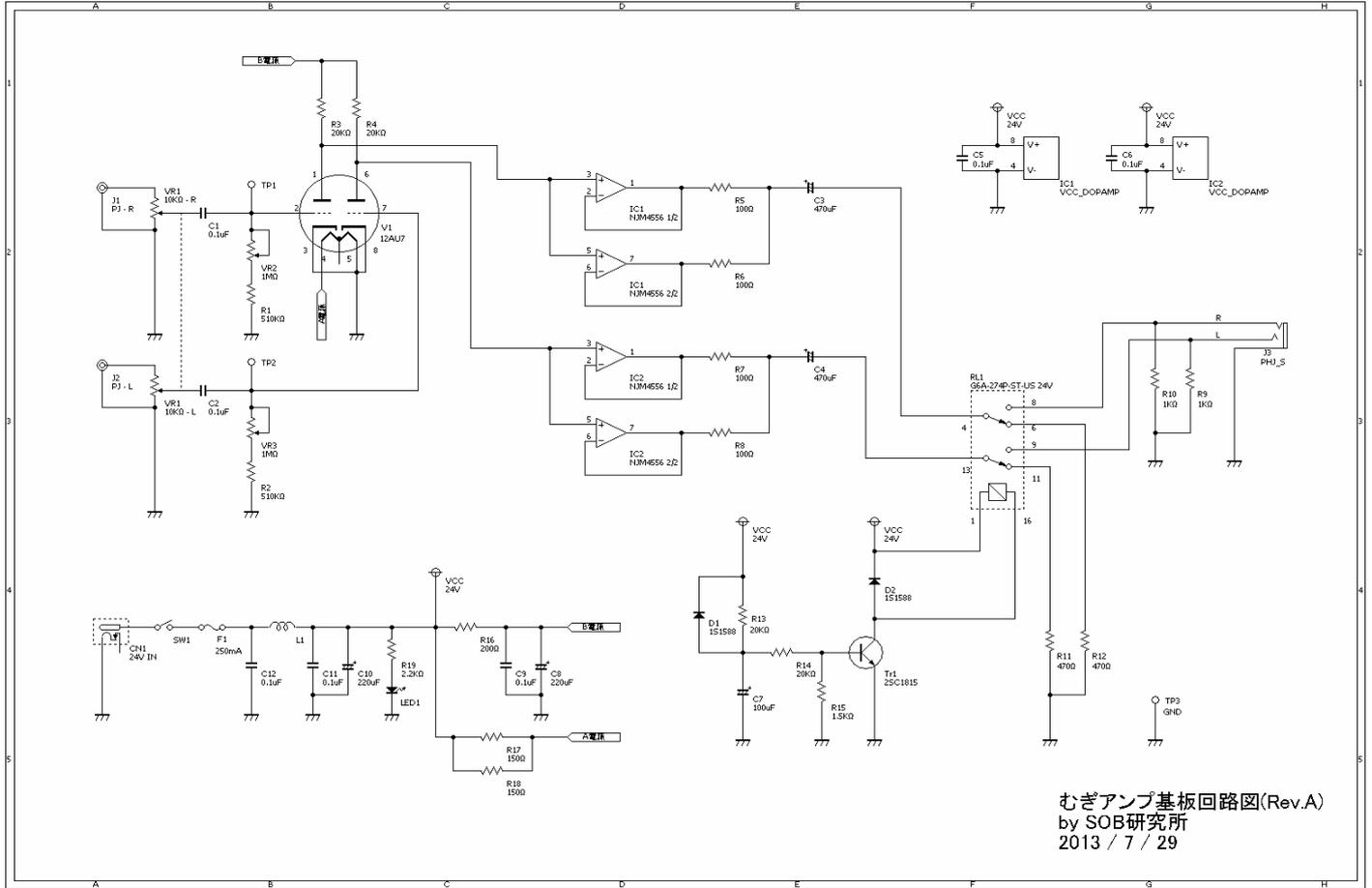
むぎアンプ基板回路図(Rev.A)
